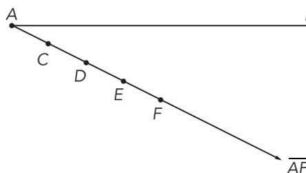
Usando a régua, traçamos a reta  $\overline{FB}$ . E usando também o esquadro, traçamos por  $E$  a reta  $\overline{ET} \parallel \overline{FB}$ , com  $T$  em  $\overline{AB}$ . Analogamente, traçamos as retas  $\overline{DS}$  e  $\overline{CR}$ .
