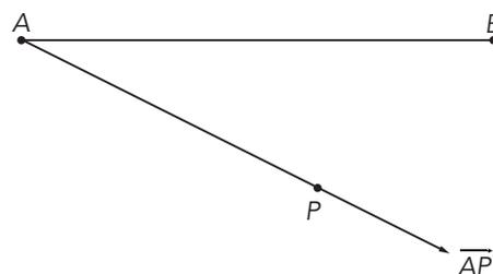
Como o segmento de reta  $\overline{AB}$  será dividido em 4 partes congruentes, usando o compasso com abertura  $a$  qualquer, marcamos em  $\overline{AP}$  4 pontos,  $C, D, E$  e  $F$ , tais que  $AC = CD = DE = EF = a$ .
