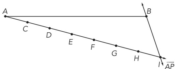
Usando régua e esquadro, traçamos por  $D$  a reta  $\overline{DJ} \parallel \overline{IB}$ , com  $J$  em  $\overline{AB}$ . O ponto  $J$  divide  $\overline{AB}$  na razão  $\frac{AJ}{JB} = \frac{AD}{DI} = \frac{2}{5}$ .
