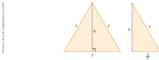
Já vimos, aplicando o teorema de Pitágoras, que a medida da altura de um triângulo equilátero de lado medindo  $l$  é dada por:  $h = \frac{l\sqrt{3}}{2}$ .
